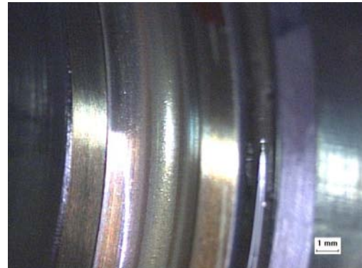
(b) Pista Externa com marca significativa de desgaste
