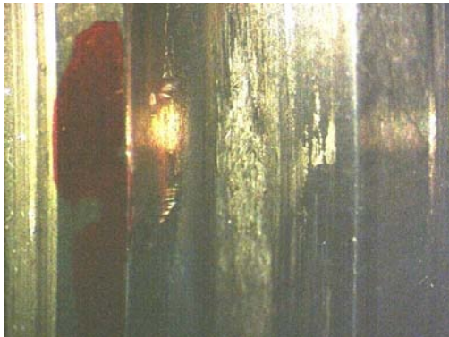
(a) Desgaste na pista interna com presença de endentações
