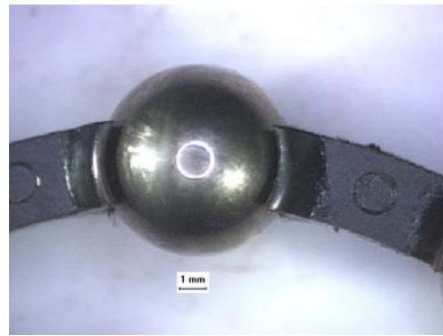
(b) Esfera e gaiola com desgaste normal
