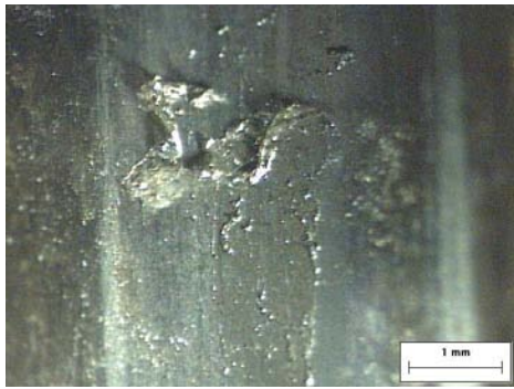
(a) Pista interna com impregnação de material da gaiola
