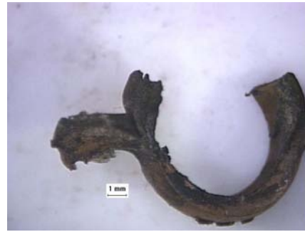
(b) Gaiola após a fusão de parte da gaiola
