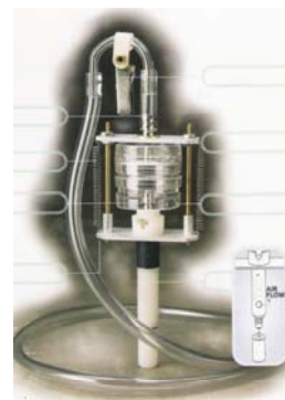
Figura 19. Montagem do porta-filtro de duas peças e ciclone (a) e conjunto montado (b).
