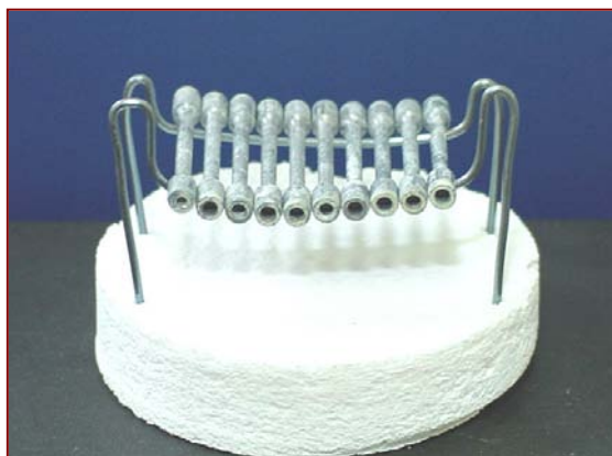
Figura 7 - Corpos-de-prova para teste de tração posicionados no suporte para realização do ciclo de cocção da cerâmica
