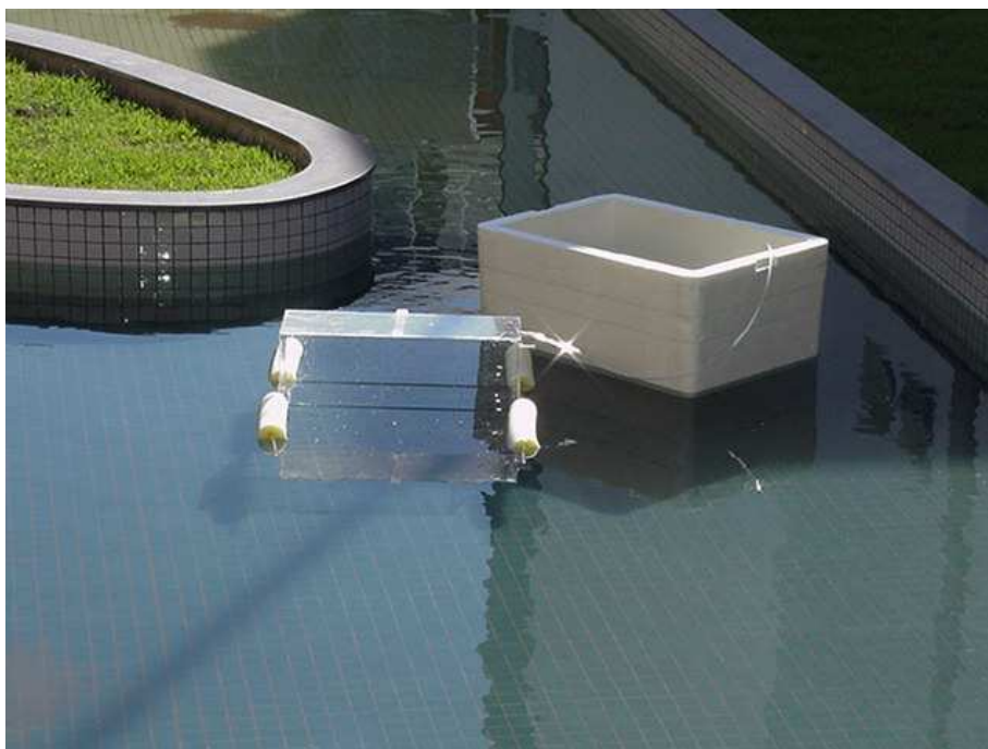
Figura 5.5 – Sistema de coleta acoplado a câmara de medição de fluxo de MDG, CEATEC, PUC-Campinas, Março, 2002.
