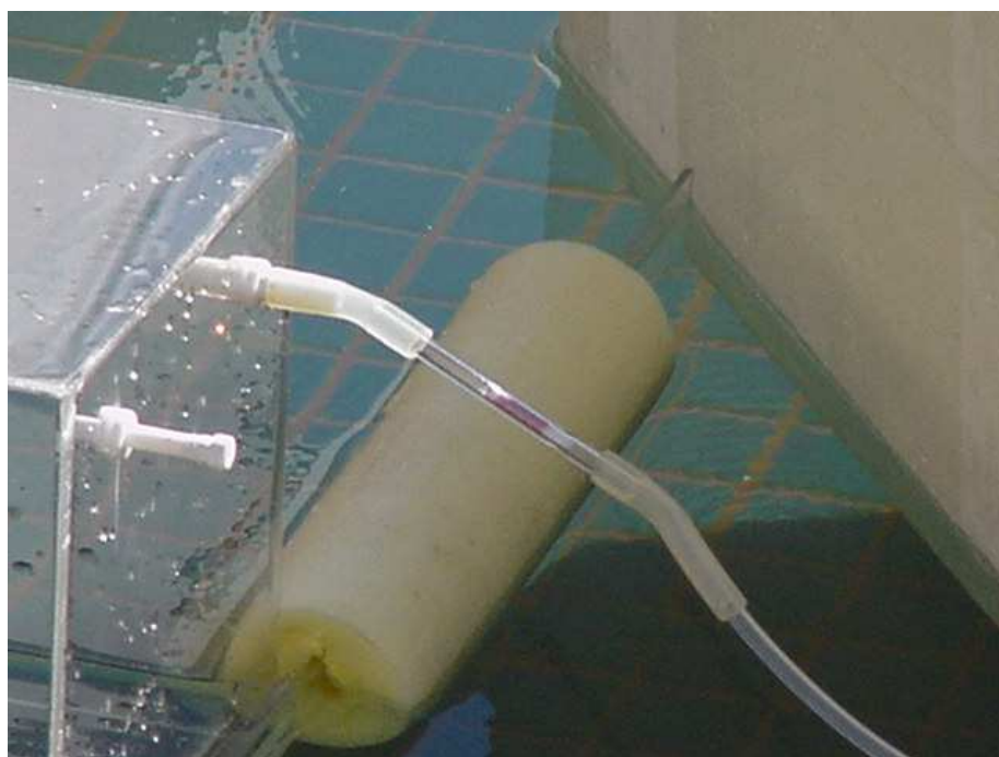
Figura 5.12 – Coluna de amostragem composta por coluna de vidro preenchida com areia de quartzo recoberta por ouro compactada por lã de vidro em teste de aplicação em campo realizado no campus da PUC-Campinas durante o ano de 2002.
