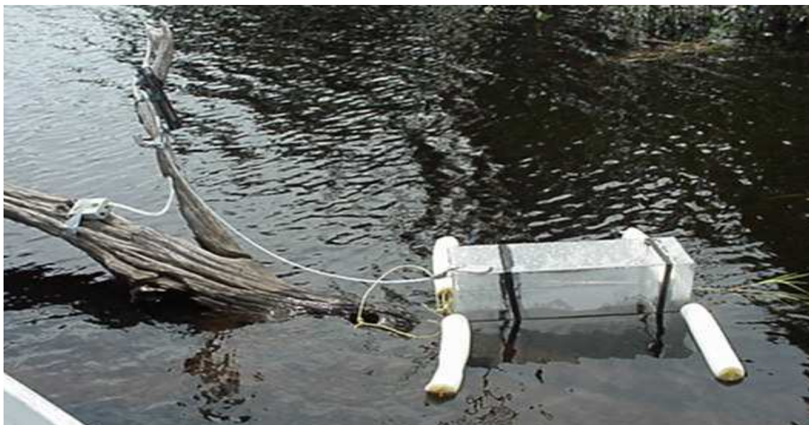
Figura 5.2 – Câmera para medição de fluxos de MDG, instalada sob o sol, no Lago Iara – AM, Janeiro, 2002.
