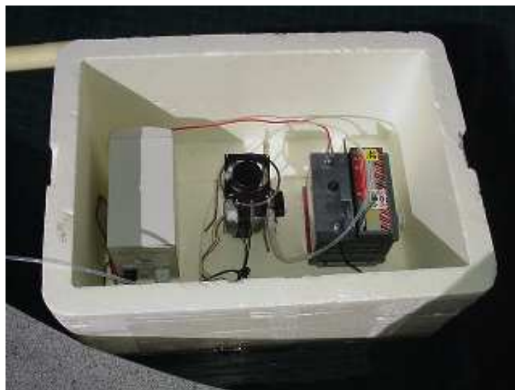
Figura 5.4 – Montagem de um sistema com vazão de 5 L min -1 , utilizando um compressor de nebulização doméstica alimentado por uma bateria chumbo / ácido de 12 volts DC, acoplada a um inversor DC / AC.
