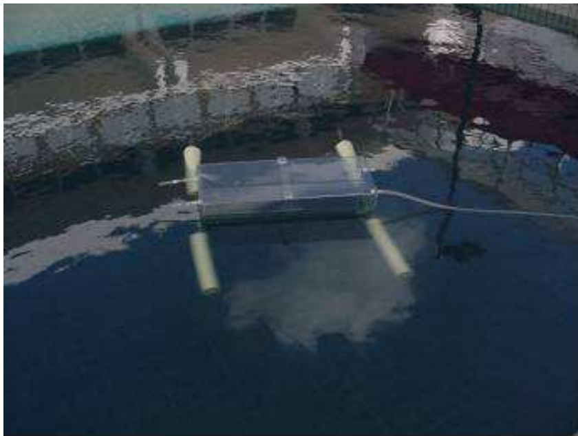
Figura 5.1 – Câmara operando com duas colunas de ouro nas entradas, o que ocasionou uma pressão negativa no seu interior e conseqüente afundamento em cerca de 30 minutos.
