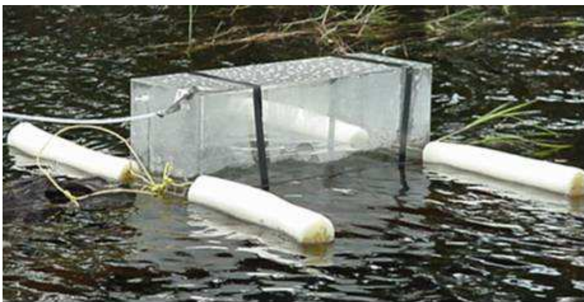
Figura 5.3 – Detalhe da condensação no interior da câmara para medição de fluxos de MDG, instalada sob o sol, no Lago Iara AM, Janeiro, 2002.
