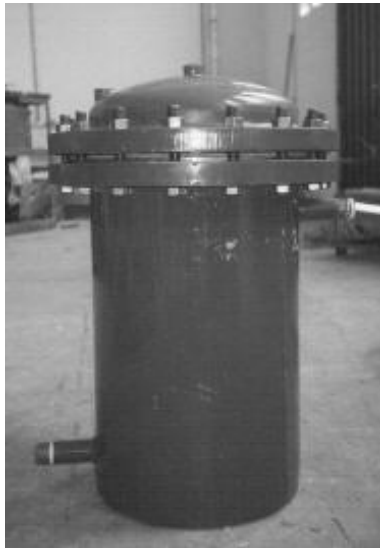
Figura 29. Reator preenchido com o leito adsortivo.
