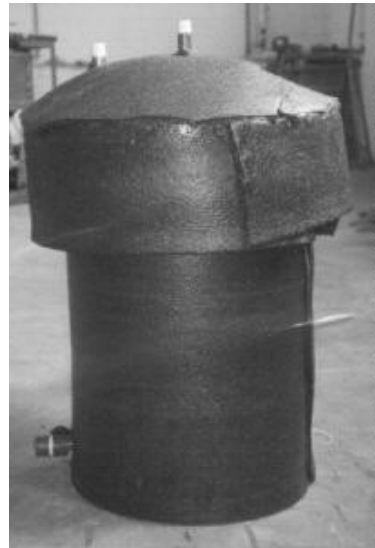
Figura 30. Reator com o leito adsortivo, depois de ser isolado termicamente.
