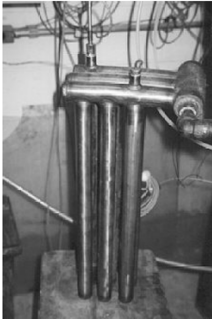
Figura 33. Evaporador de amônia multitubular para produção de gelo (projeto inicial).
