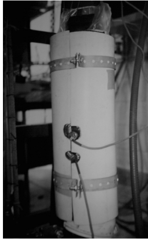
Figura 35. Gabarito para fixação da embalagem de PEBD com água ao redor do evaporador.
