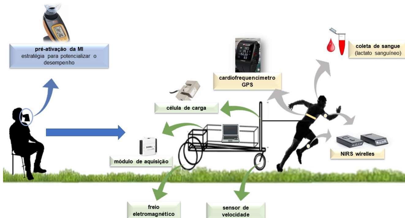
Figura 9. Equipamentos utilizados nas sessões caracterizadas por Sprints Repetidos (RAST) utilizando o carro de resistência variável (CRV), precedidos ou não pela pré-ativação de músculos inspiratórios.
