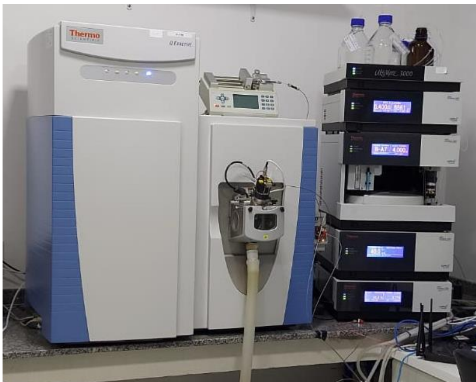
Figura 16. Foto do sistema HPLC UltiMate™ 3000 Standard Binary System (Thermo Scientific™, Waltham, MA, USA) acoplado com um espectrômetro de massas Orbitrap Q Exactive™ Focus (Thermo Scientific™, Waltham, MA, USA) equipado com uma fonte eletrospray (ESI) utilizado na presente tese de doutorado.
