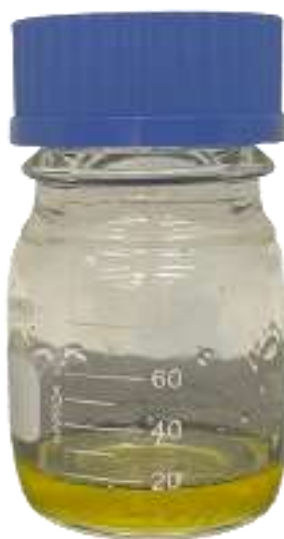
Figura 17. Extrato obtido por SFE da amêndoa de pequi a 35 MPa e 40 °C.
