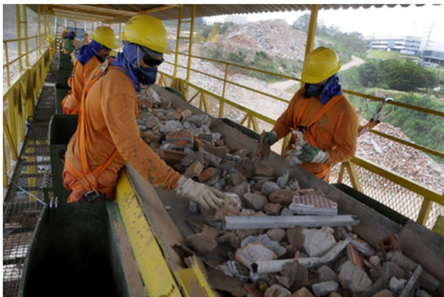
Figura 22. Esteira de Triagem (“big station”) Geresol Jundiai
