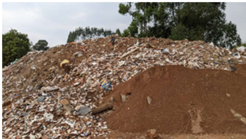
Figura 58- RCD recebidos na Usina com alto índice de rejeito.
