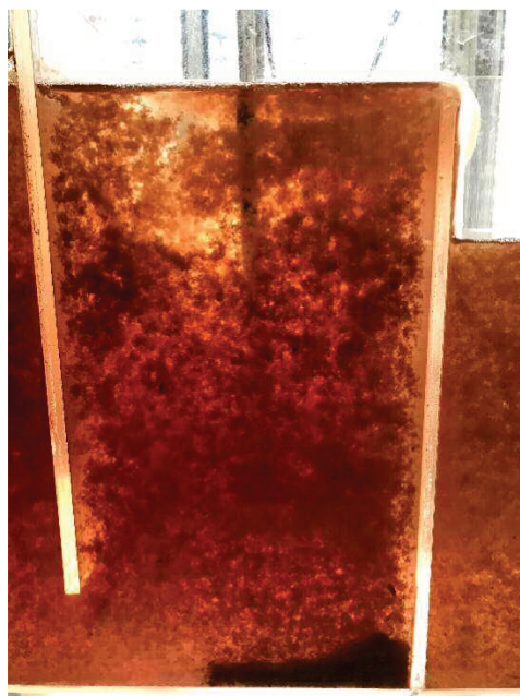
Figura 30. Registro fotográfico da etapa de coagulação. Imagem parcial do floculador em operação com flóculos em processo de formação sob agitação e suspensão.
