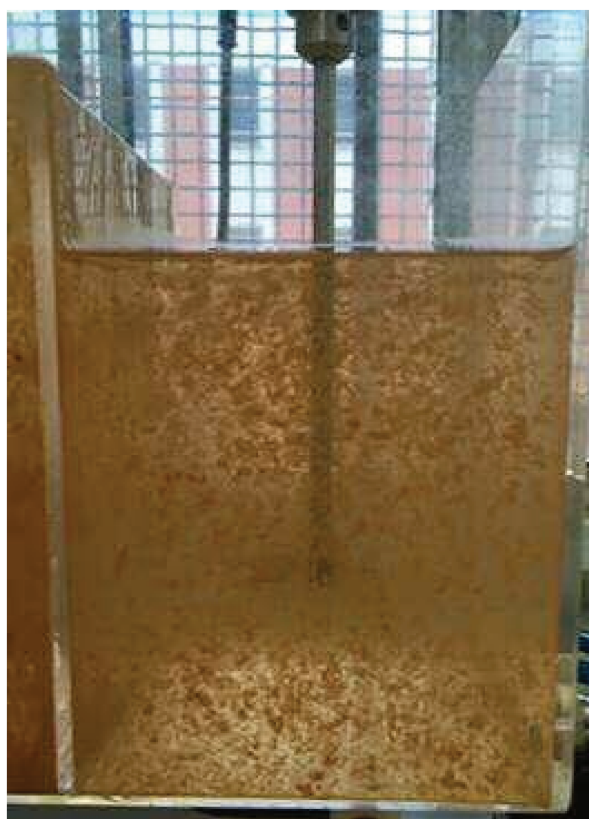
Figura 31. Imagem parcial do floculador em operação durante etapa de coagulação/floculação visando a determinação da dosagem ideal de reagentes Aluminato de Sódio e Tanfloc SG, com efluente ajustado em 25 NTU, apresentando flóculos em processo de formação sob agitação e suspensão.
