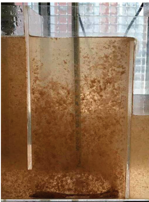
Figura 32. Imagem parcial do floculador em operação durante etapa de coagulação/floculação visando a determinação da dosagem ideal de reagentes Aluminato de Sódio e Tanfloc SG, com efluente ajustado em 50 NTU, apresentando flóculos em processo de formação sob agitação e suspensão.
