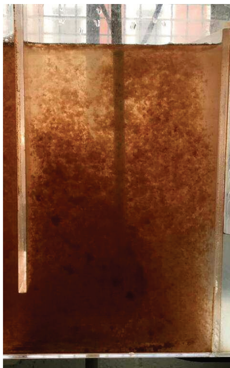
Figura 33. Imagem parcial do floculador em operação durante etapa de coagulação/floculação visando a determinação da dosagem ideal de reagentes Aluminato de Sódio e Tanfloc SG, com efluente ajustado em 75 NTU, apresentando flóculos em processo de formação sob agitação e suspensão.
