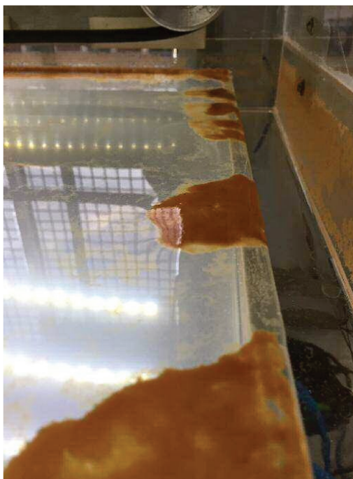
Figura 14. Registro fotográfico do tanque de flotação em operação – Imagem parcial da zona de separação com a “manta” de floculos flotados em processo de deslocamento superficial de sólidos e escoamento para a canaleta de descarte.
