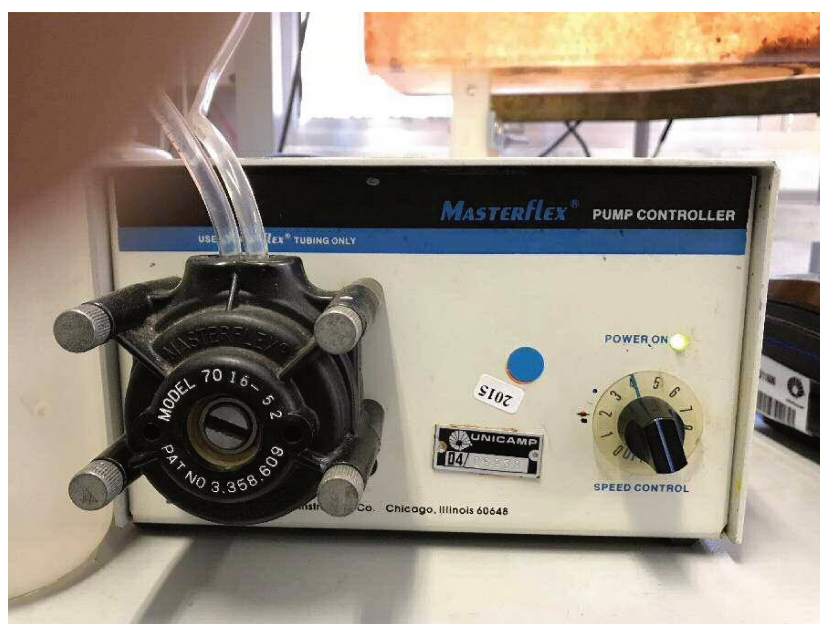
Figura 27. Ilustração da bomba dosadora peristáltica utilizada para dosagem contínua do reagente Aluminato de Sódio.
