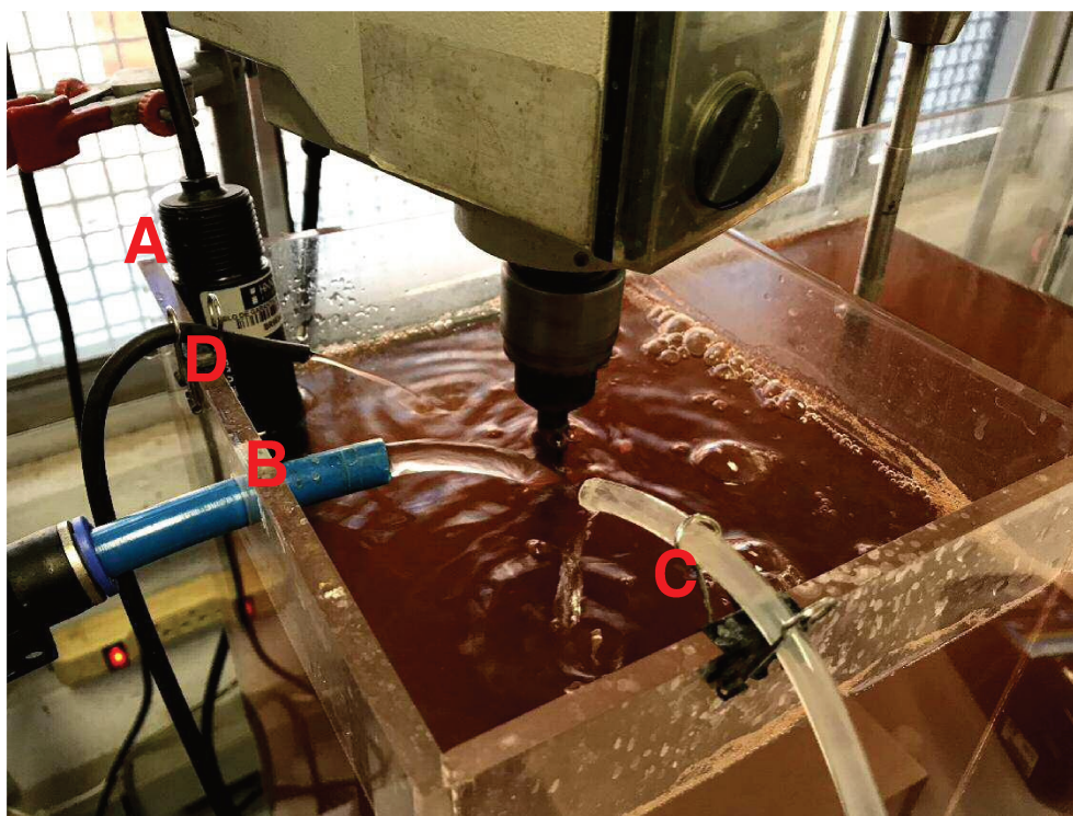
Figura 8. Ilustração parcial do tanque de floculação – primeiro estágio ou zona de mistura rápida. (a) Eletrodo do pHmetro on-line ; (b) tubulação de entrada de água bruta; (c) ponto de dosagem da solução de reagente Aluminato de sódio e (d) ponto de dosagem da solução reagente de Tanfloc SG.
