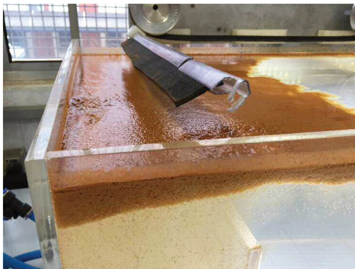
Figura 13. Imagem parcial do tanque de flotação: Evidência fotográfica da formação da “manta” de floculos recém flotados e acumulados na parte superior da zona de contato em deslocamento sentido a zona de separação.
