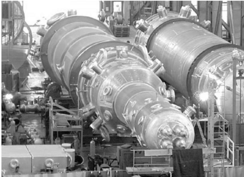
**Figura 5.4:** Casco externo do trocador de calor em espiral usado em plantas de GNL.
