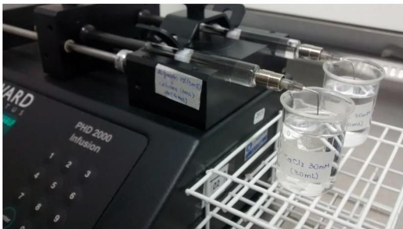
**Figura 5.3:** Processo de produção de macropartículas de alginato pelo método de gotejamento usando uma vazão de  $1 \text{ mL}\cdot\text{min}^{-1}$  para gotejar solução de alginato de sódio num reservatório contendo solução de  $\text{CaCl}_2$  a 30mM.
