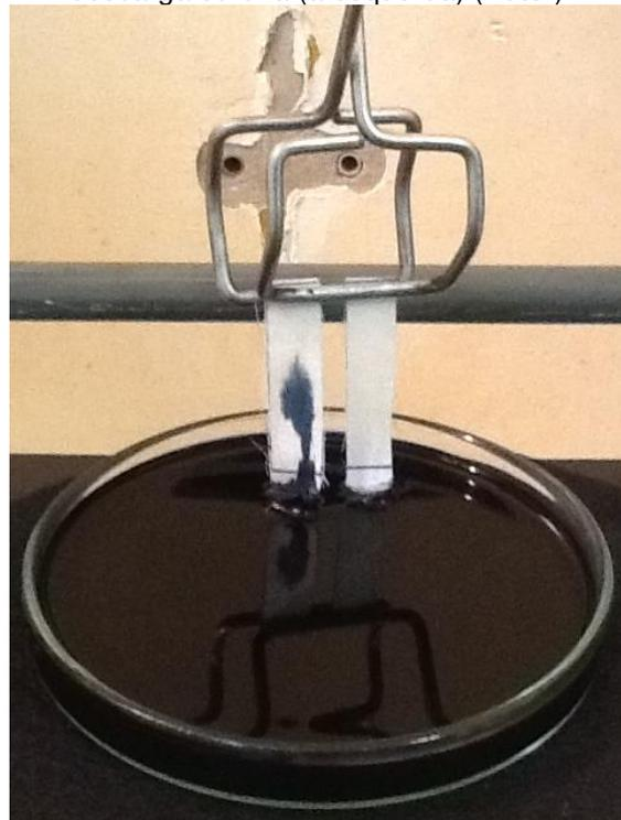
Na Fig. 50 observam-se os resultados dos ensaios para amostras cruas (à direita) e tratadas com sabão de Marselha (à esquerda), sendo visível que as amostras cruas não absorvem água e as tratadas por sabão de Marselha
