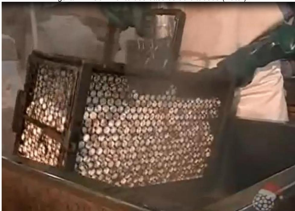
Em média este processo de cozimento dura 20 minutos. Após este processo se faz a última seleção dos casulos separando-os em manchados, os de casca fina, os deformados e os sujos para a fiação de fio tipo 2 e o restante vai para a fiação tipo 1 (fiação de primeira qualidade).
