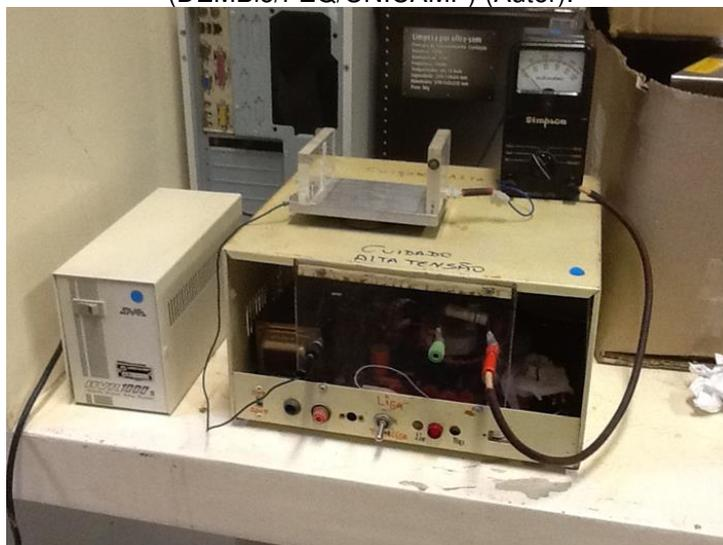
Figura 41 - Sistema 2 de descarga corona composto pela fonte de alta tensão, suporte de amostra e 3 fios corona, confeccionado pelo Prof. Sinézio (DEMBio/FEQ/UNICAMP) (Autor).
