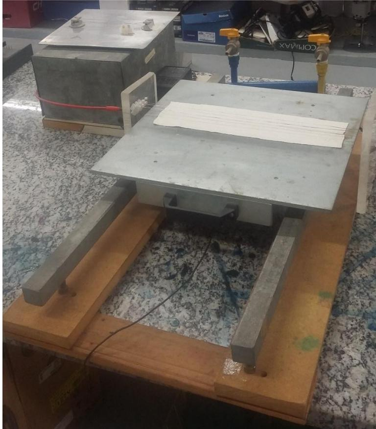
Figura 42 - Detalhe dos três fios corona do sistema 2 de descarga corona (Autor).
