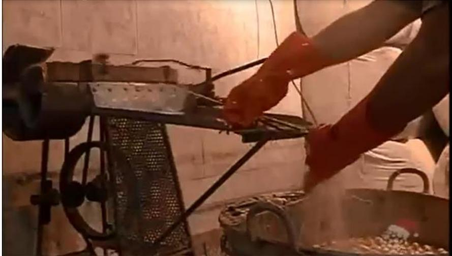
Após a formação da bobina nas máquinas de fição manual, os fios de seda devem ser repassados para outras bobinas para formar meadas ou mesmo bobinas para o processo de torção (Fig. 14).
