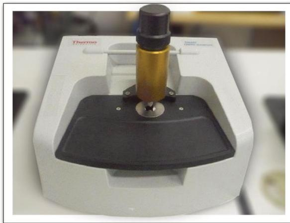
Figura 5.1 - Espectrômetro de infravermelho, modelo Nicolet 6700, marca Thermo.
