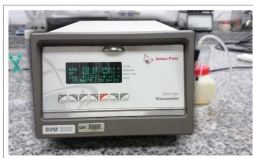
Figura 7.2 - Viscosímetro Stabinger da Anton Paar (SVM 3000)
