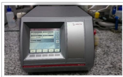
Figura 7.1 - Analisador de densidade e velocidade do som da Anton Paar (DSA 5000)
