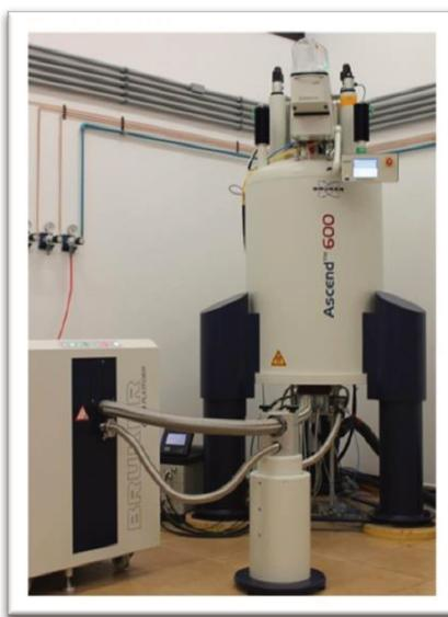
Figura 5.2 - Espectrômetro Bruker Avance III 600.
