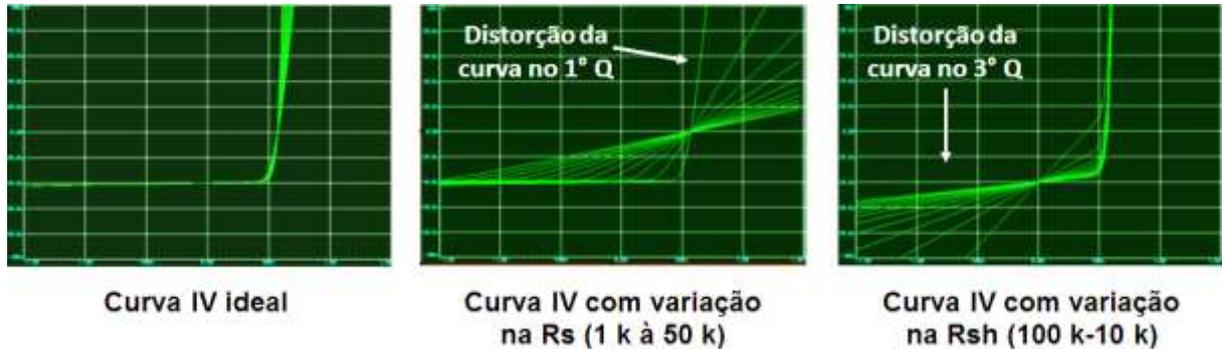
**Figura 53:** Simulação de curva IV, mostrando a interferência da  $R_s$  e  $R_{sh}$  na curva. Da esquerda para a direita tem se curva ideal; curva com distorção no 1º quadrante causada pelo aumento da  $R_s$  e com distorção no 3º quadrante causada pela diminuição da  $R_{sh}$  (Fonte: programa ISIS Professional-simulador *solar cell*).
