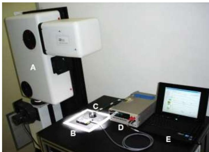
**Figura 62:** Fotos da montagem experimental mostrando o sistema de caracterização elétrica para células solares através de luz solar simulada. (A) simulador solar com filtros AM 1.5G; (B) célula solar padrão para calibração; (C) sensor de radiação solar calibrado; (D) eletrômetro Keithley e (E) computador com software para caracterização.
