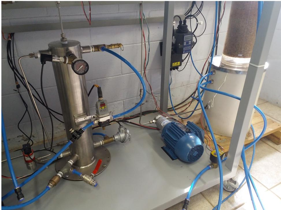
Figura 20 – Sistema de saturação da água.
