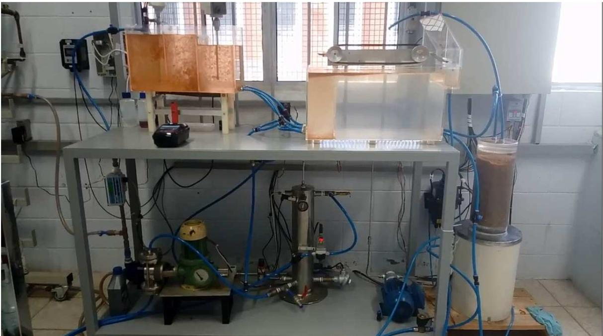
Figura 14 – Protótipo de flotação por ar dissolvido.
