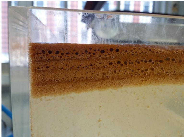
Figura 18 – Detalhe da camada de material flotado formada acima da zona de contato.
