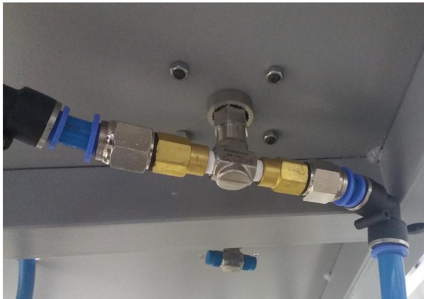
Figura 22 – Válvula agulha de  $C_v$  igual a 0,03.
