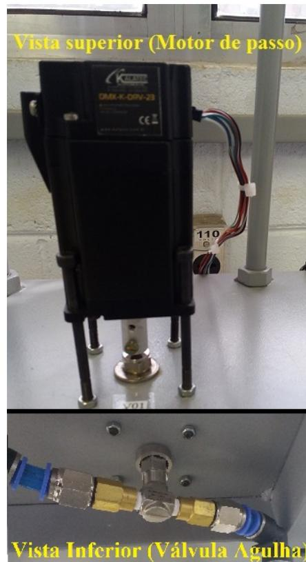
Figura 29 – Conjunto motor de passo e válvula agulha.
