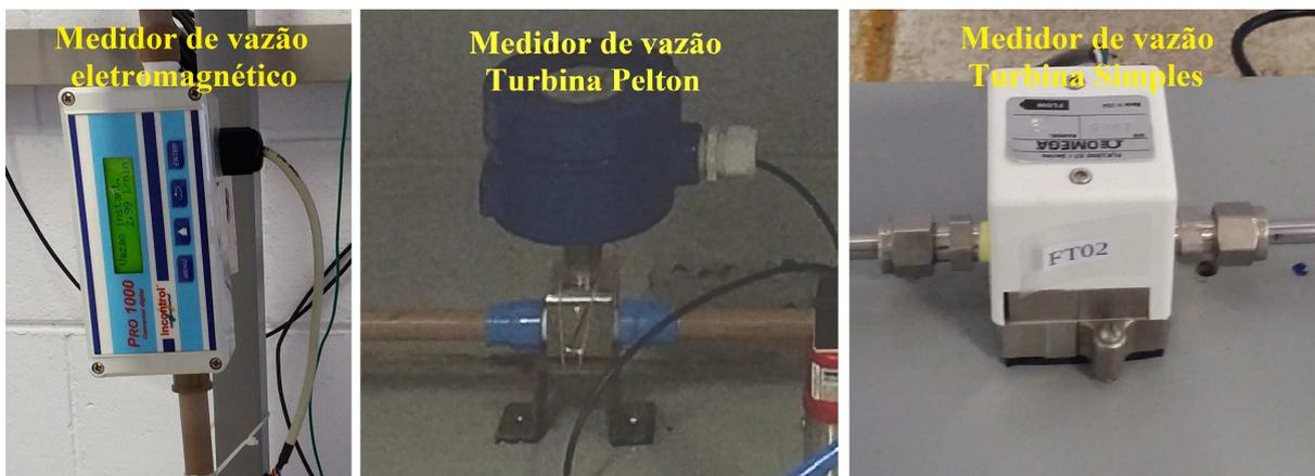
Figura 37 – Medidores de vazão empregados no protótipo de FAD.
