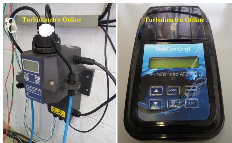
Figura 36 – Turbidímetros *online* e *offline* do sistema de FAD.
