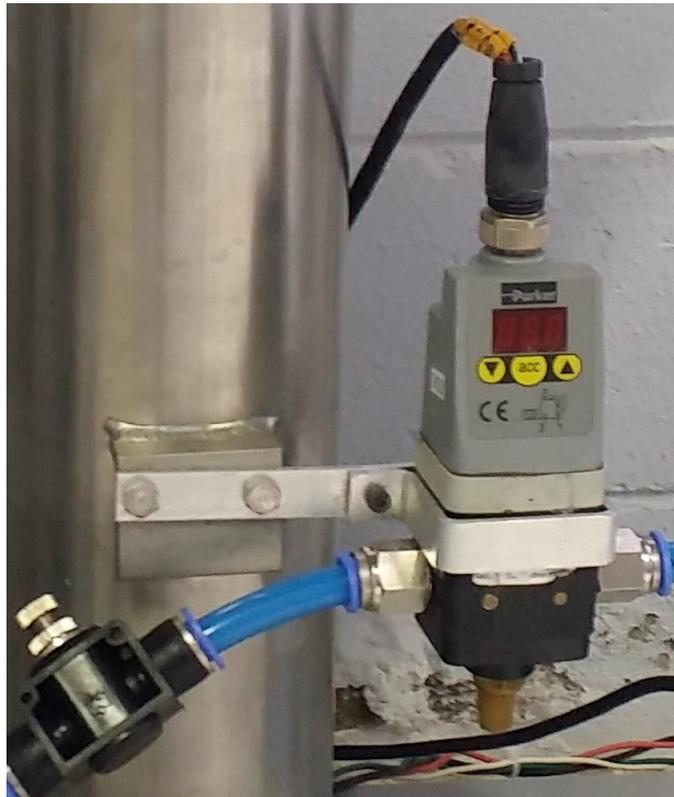
Figura 33 – Válvulas reguladoras de pressão e de fluxo do vaso saturador.
