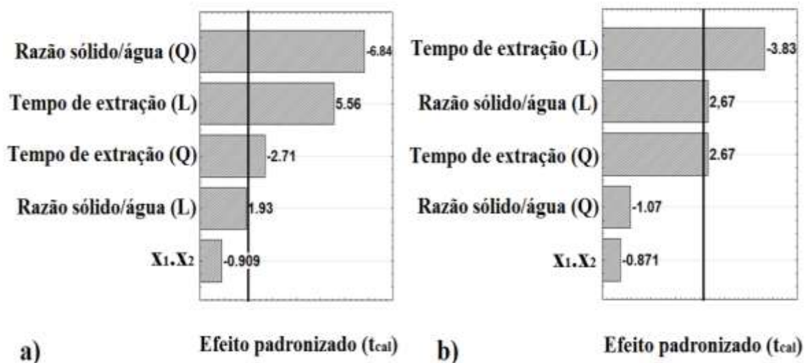
Figura 3.10 – Diagramas de Pareto para as respostas: a) rendimento em base seca; b) teor de \delta -3-careno no óleo essencial.
