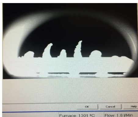
Figura 3.4 Imagem dos cones de cinzas durante análise por AF 700.
