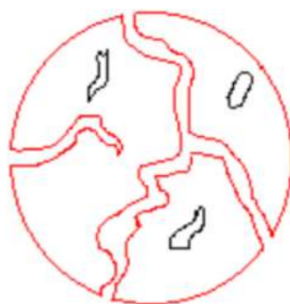
Figura 2.24 Área superficial específica total delimitada em vermelho no desenho (Greeg e Sing, 1982).
