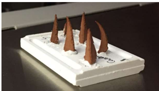
Figura 3.3 Cones de cinzas de bagaço moldados e prontos para análise.
