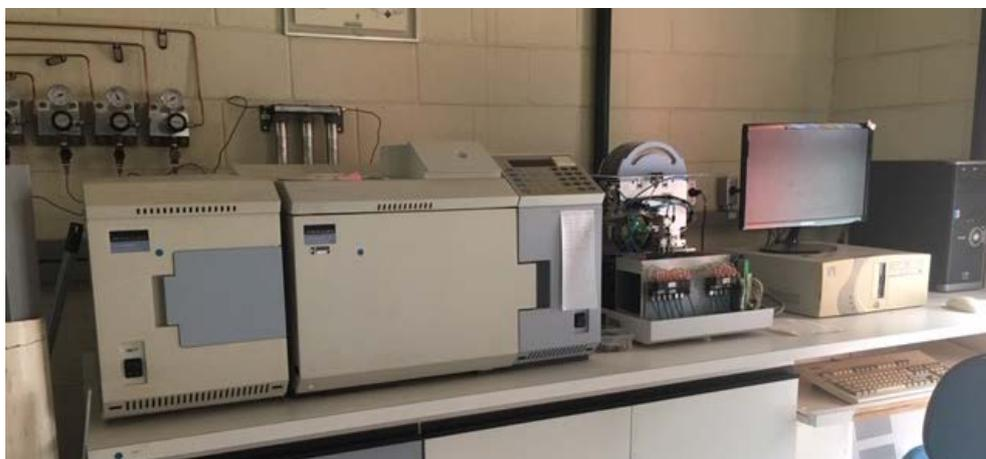
**Figura 35: Cromatógrafo gasoso com detector de massa acoplado (GC-MS), utilizado na identificação de compostos intermediários (Laboratório de Pesquisas e Desenvolvimento de Tecnologias Ambientais - Faculdade de Engenharia Química, UNICAMP)**
