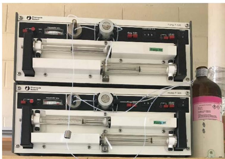
**Figura 23: Bombas para dosagem de  $H_2O_2$ .**
