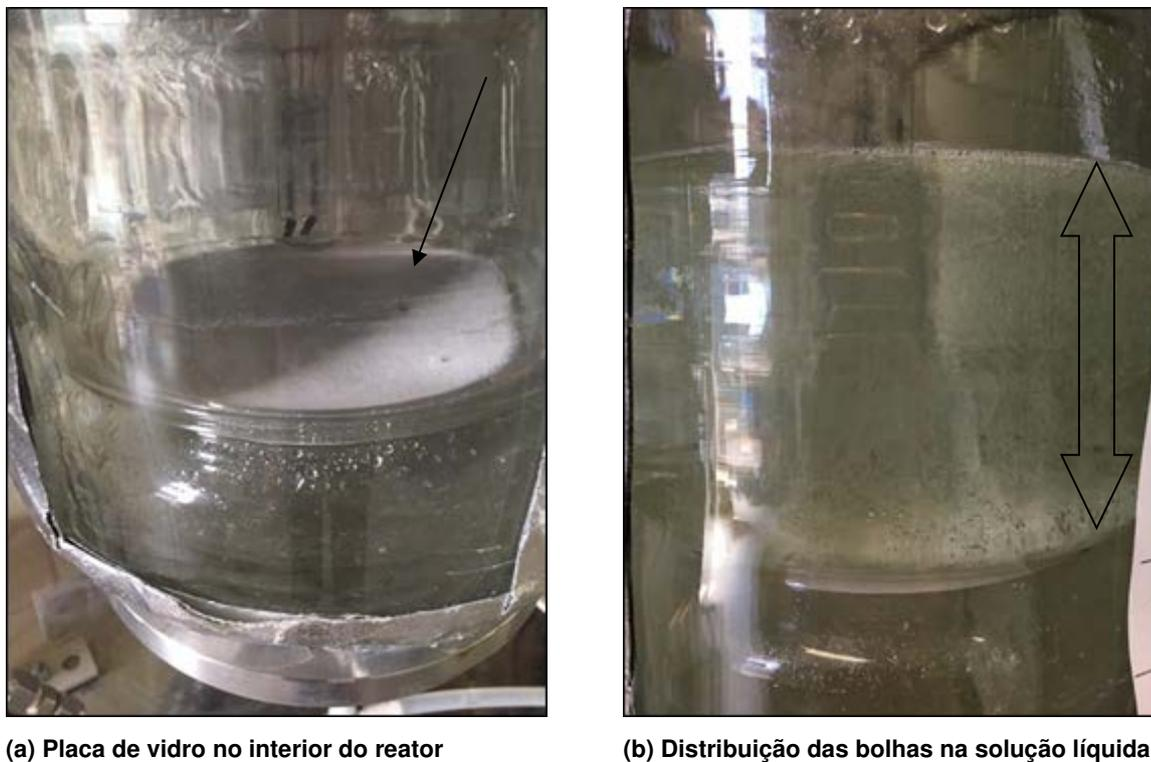
**Figura 21: Distribuição das bolhas no interior do reator**
