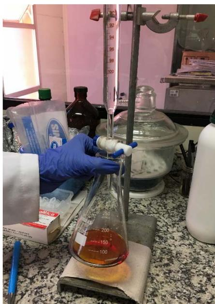
**Figura 56: Início da titulação da solução da coluna de ozonização com  $\text{Na}_2\text{S}_2\text{O}_3$**
