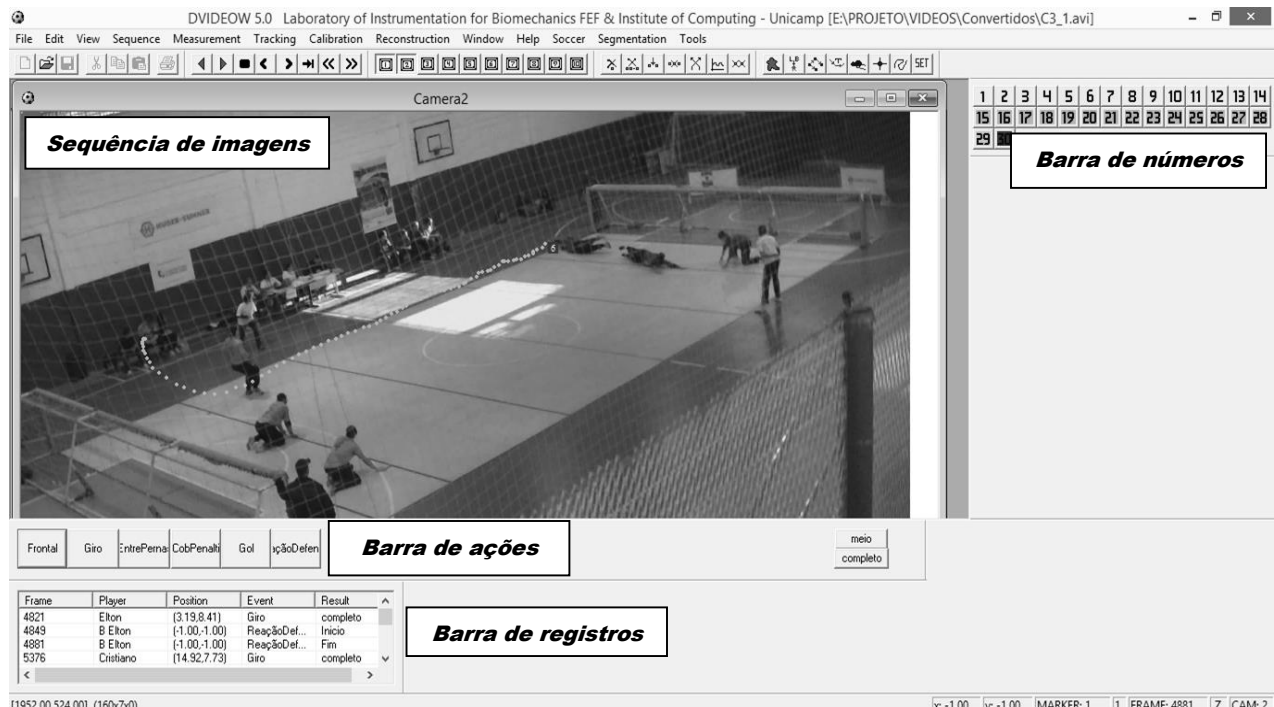
Figura 4.4. Interface de scout do software Dvideo.
