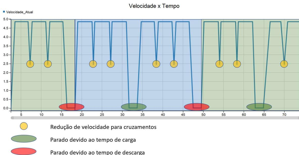
**Figura 4.11 - Detalhamento dos motivos das reduções de velocidade da empilhadeira ao longo do tempo**
