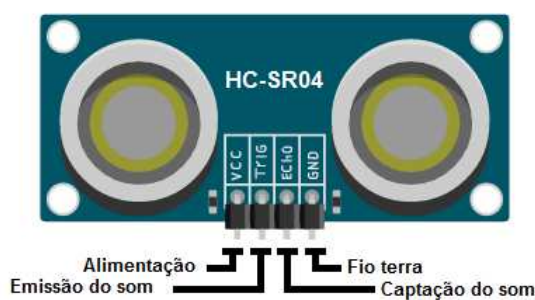
Figura 12. Desenho esquemático do sensor de distância ultrassônico HC-SR04 (fonte autor).
