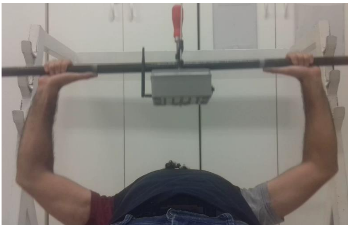
Figura 22. Imagem do sistema captador e emissor de sinais anexado a barra de supino.
